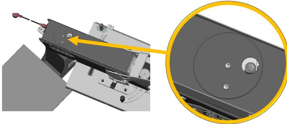
2) Pour activer le système auto-swing, faire tourner le capot (1 sur la photo) et appuyer sur le bouton (2 sur la photo)
